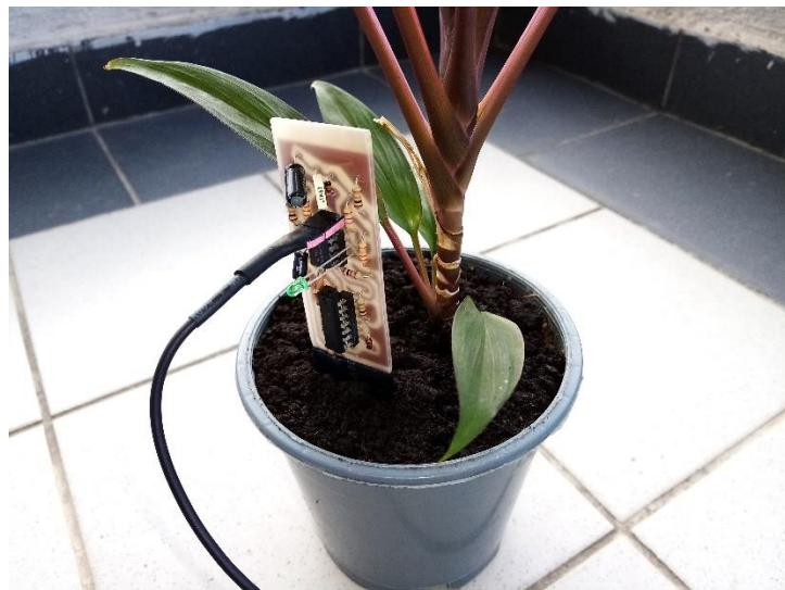
Slika 7.4: Senzor vlažnosti zemljišta u saksiji
